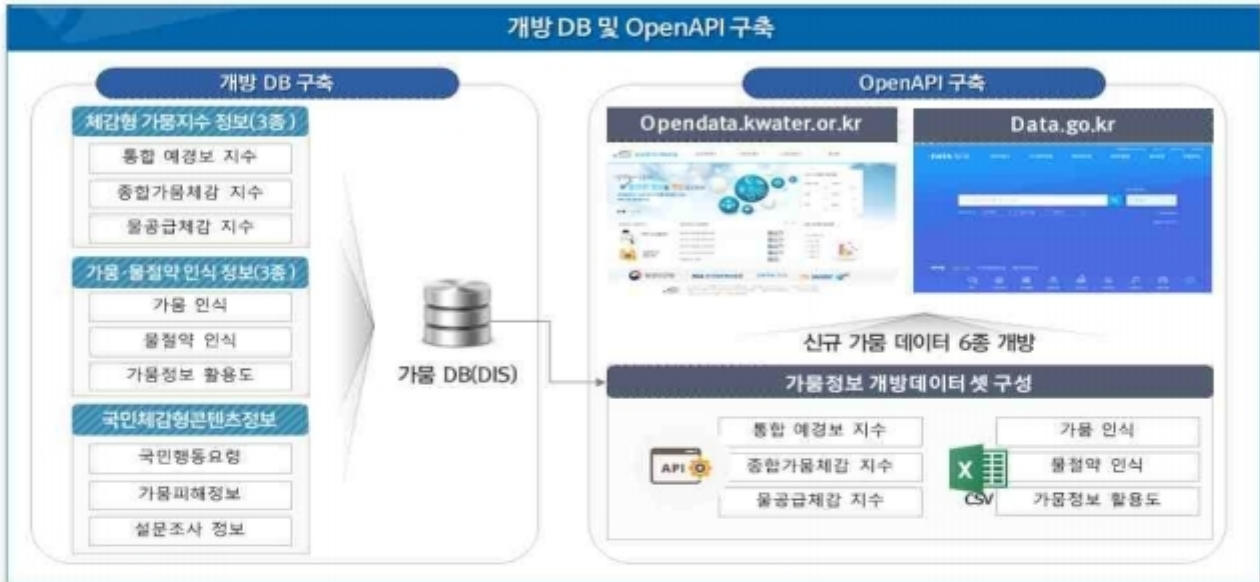
그림 7.23 개방 DB 및 OPEN API 개념도
